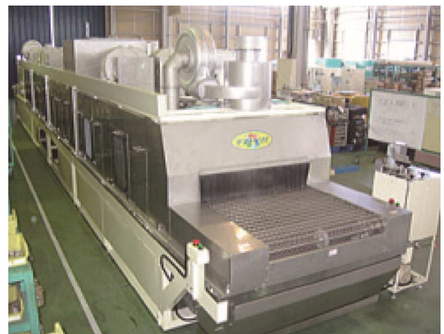
図2 T社の電解アルカリイオン水洗浄機 (水系脱脂洗浄) (出典) T社ウェブサイト
